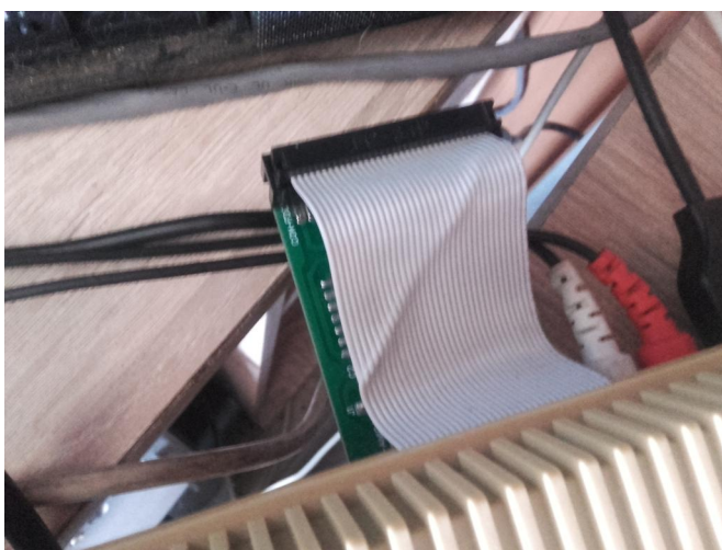
Zewnętrzny interfejs stacji dyskietek w porcie Disk Drive. Stacja dyskietek jest zamontowana wewnątrz Amigi.
